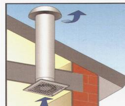
**Estrattori elicoidali da muro o da soffitto**
