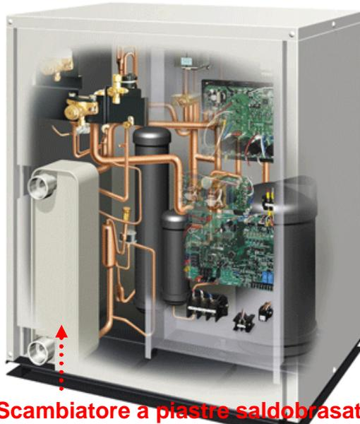
**Scambiatore a piastre saldobrasato, in controcorrente e flussi paralleli a garantire elevate prestazioni e semplicità di installazione. Le piastre sono in acciaio inox AISI 316L con brasatura in rame puro al 99%,**
